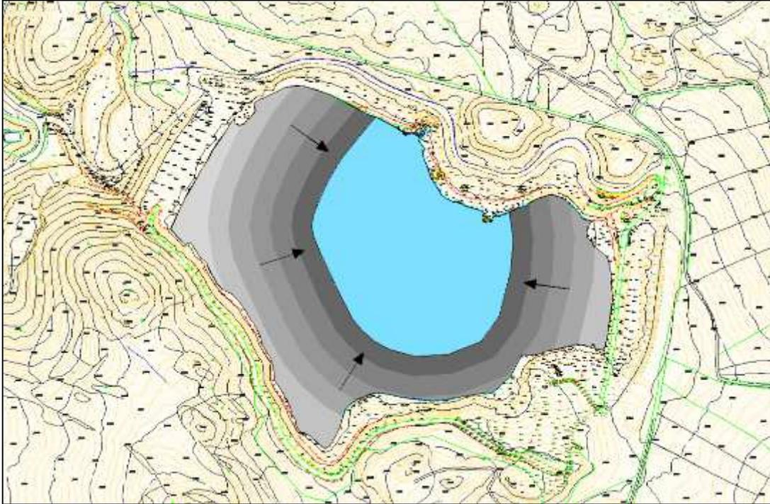
Fig. 6. Fase iniziale del colmamento del bacino per fasce parallele dall'esterno verso l'interno
